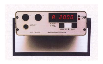
Das MO 2A wird verwendet zur Messung von Verbindungswiderständen. Das dabei verwendete Meßverfahren basiert auf der Strom-/Spannungsmessung und anschließender Berechnung und Anzeige des Widerstandswertes. Durch das Meßobjekt wird während der Messung ein pulsierender Gleichstrom von ca. 20 A geschickt. Die Steuerung des Meßablaufes mittels Mikrokontroller beseitigt Meßfehler durch Störpotentiale (z.B. Thermospannungen) oder Nullpunktdriften.
