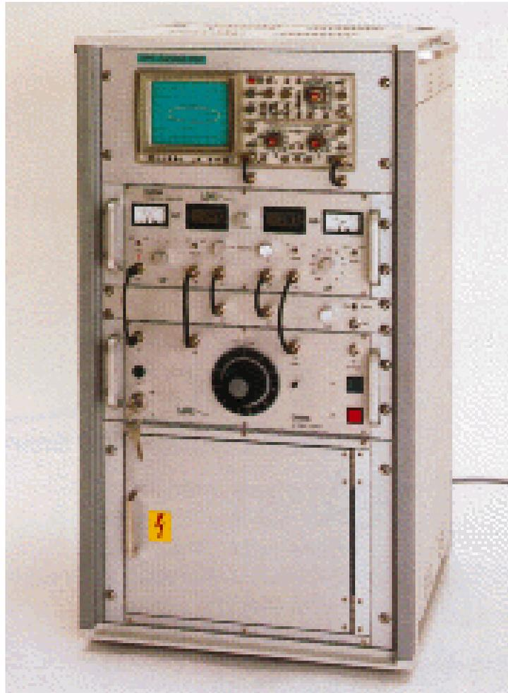
Der **D**ielektrische **A**Nalysator **D**IANA ist ein neuartiges Meßgerät zur Bestimmung des Verlustfaktors von Isolierstoffen.
